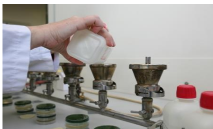
Figure 5 : Rampe de filtration.
