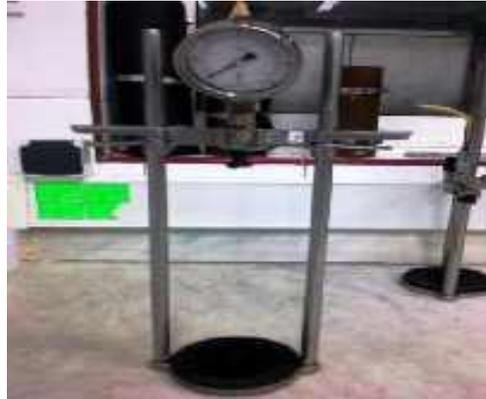
**Figure 1 : Zahm munie d'un manomètre**
