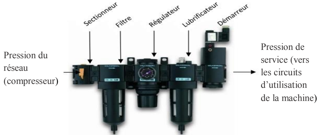
Figure 38: Ensemble de conditionnement d'air
