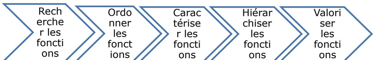
**Figure II.3 : La pratique de l'analyse fonctionnelle**
