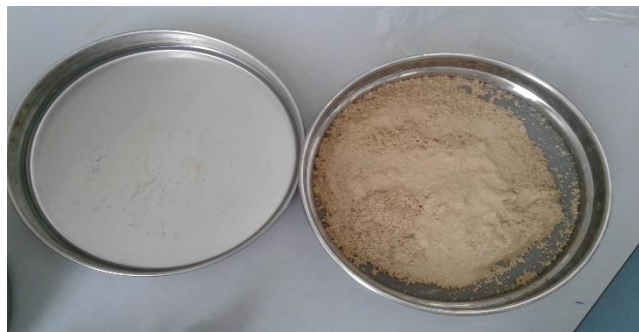
Figure18 : Boues après drainage
