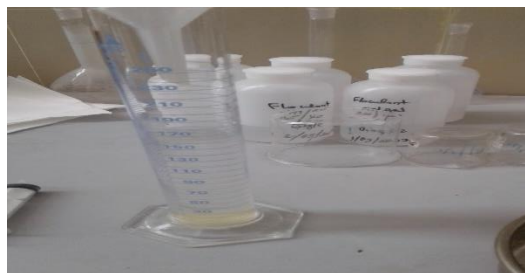
Figure 19 : Mesure du volume de l'eau récupérée
