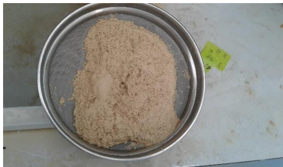
Figure17 : la boue après ajout du flocculant et le malaxage
