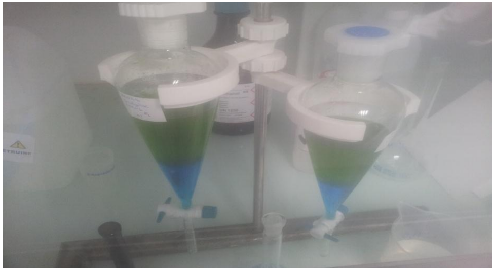
Figure 7 : Extraction du cinéol par le dichlorométhane.
