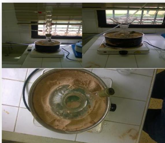
**Figure 7:** Image illustrant la Méthode du chauffage à reflux.
