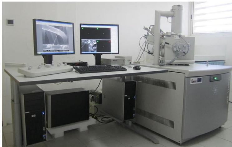
**Figure 4:** Image de l'appareille de microscopie électronique à balayage « Quanta 200 FEL équipé de sonde EDAX ».
