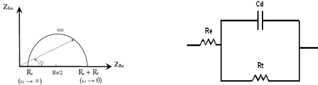
Figure II.8: Graphe de Nyquist (réaction avec transfert de charge) et son circuit équivalent
