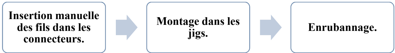
Figure 17 : Processus de réalisation du câble dans le poste 2
