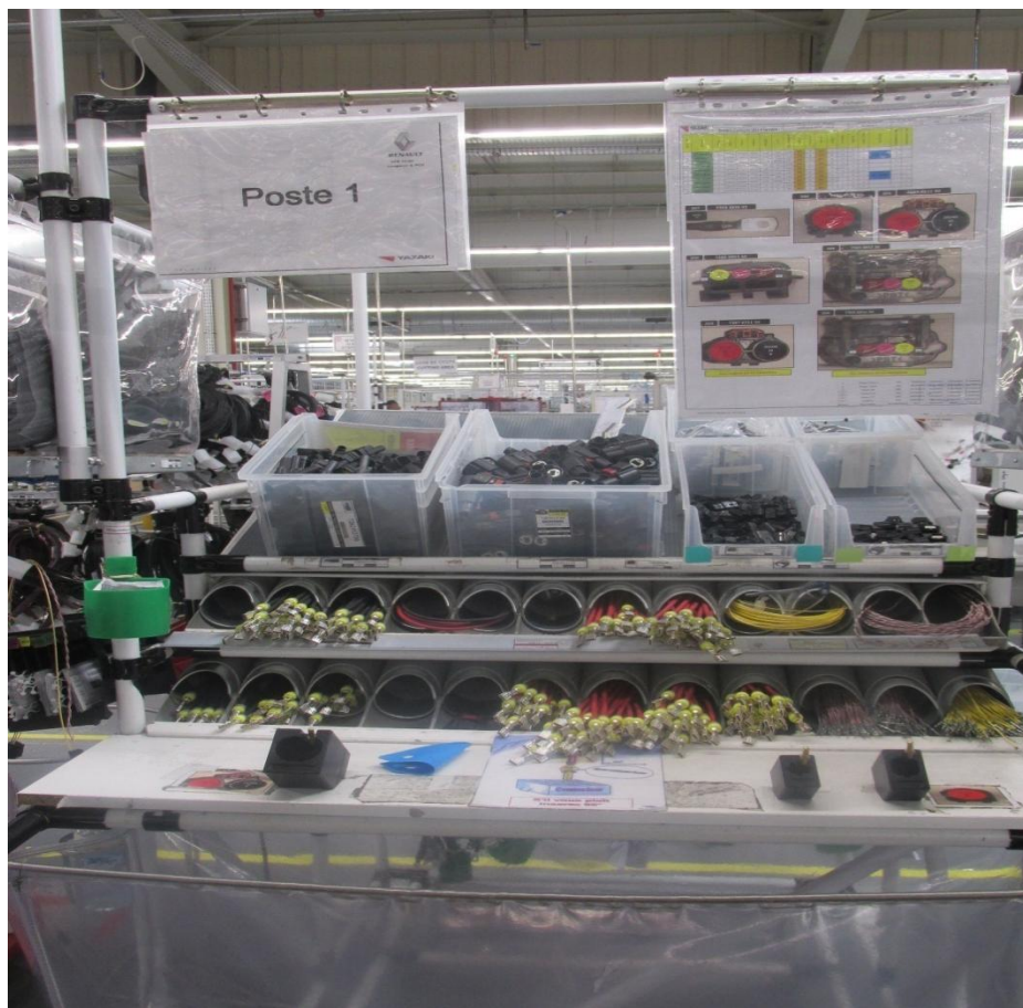
Figure 16 : Poste 1 d'insertion dans la chaîne longeron DAE
