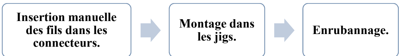
Figure 18 : Processus de réalisation du câble dans le poste 3
