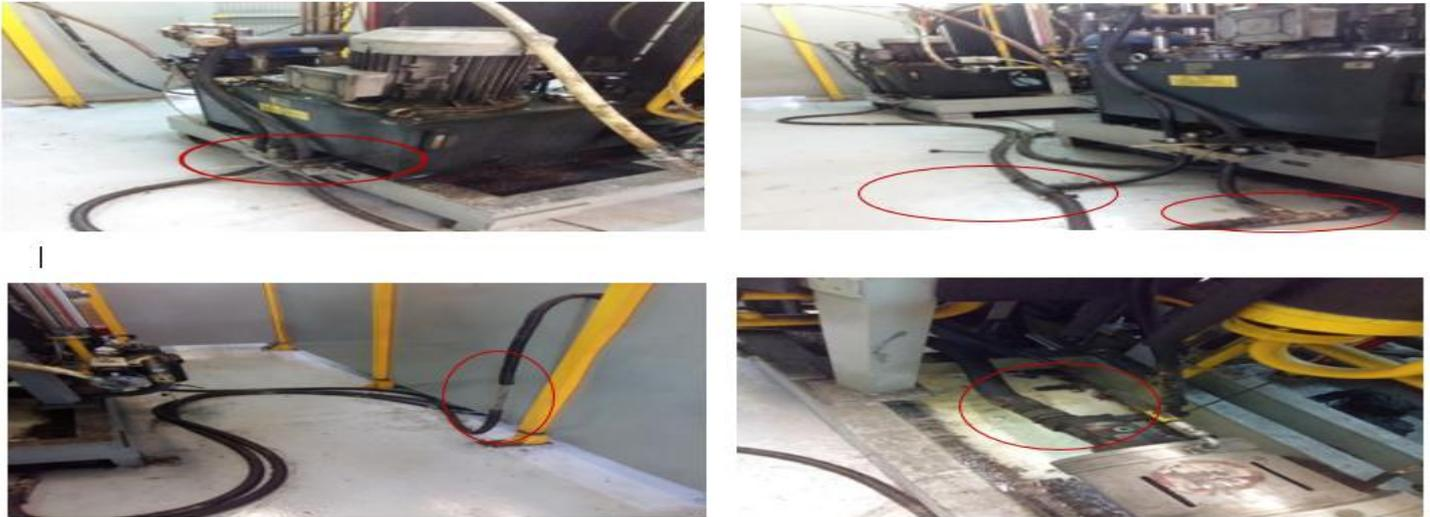
Figure 16: les pannes du système hydraulique
