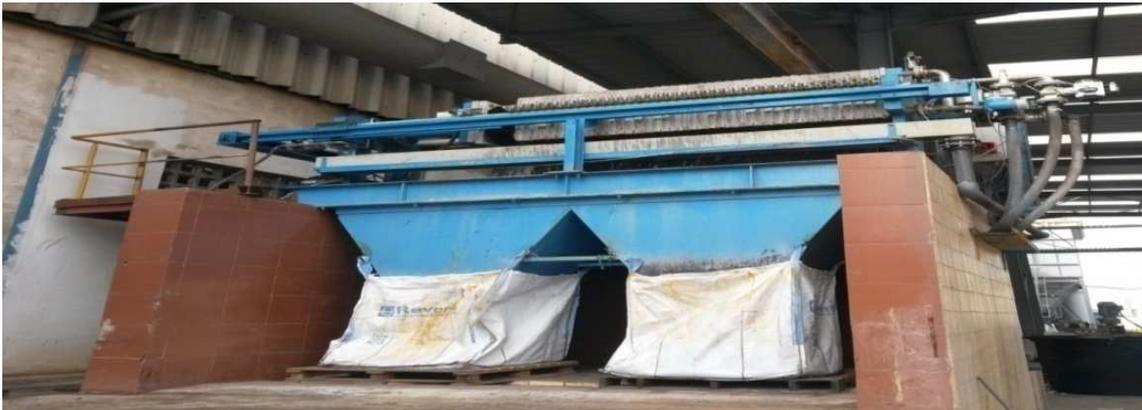
**Figure 22:** Filtre presse à plateaux
