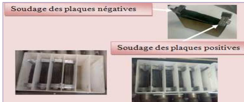
**Figure 11:** Soudage et empilage des groupes de plaque
