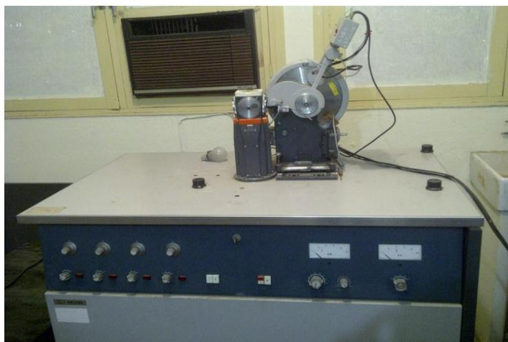
Fig.II.3 : Photo du diffractomètre PHILIPS PW 1800
