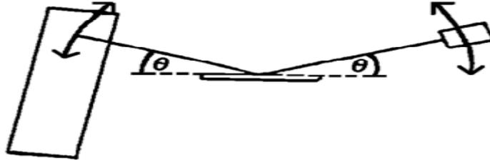
Fig.I.12 : Schéma explicatif de la géométrie  $\theta$ - $\theta$  [25]
