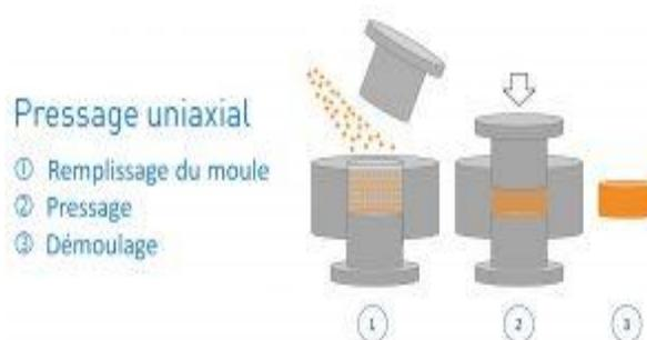
Fig.I.10 : Moule pour le pressage uniaxial
