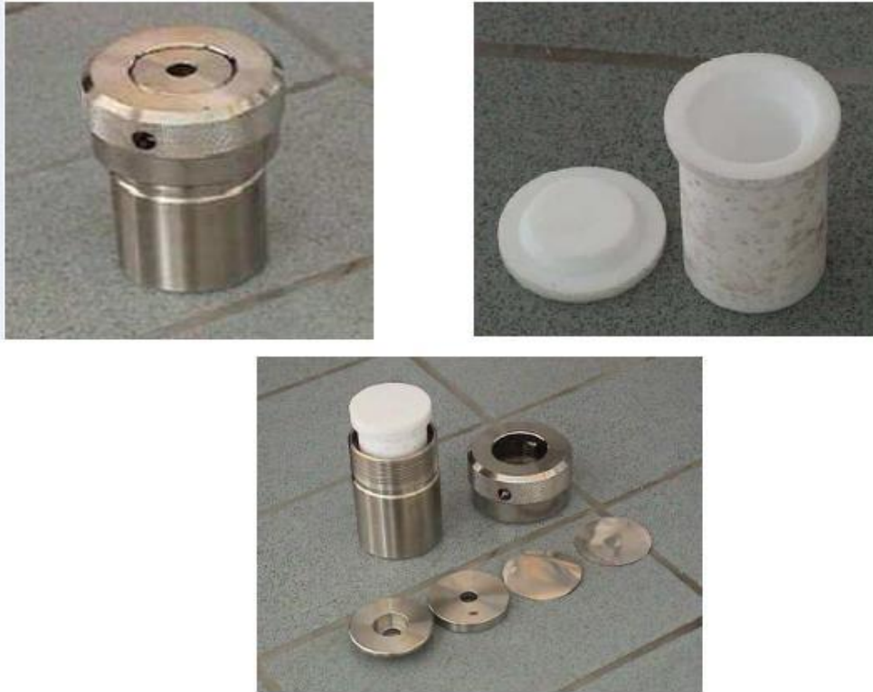
Figure 12 : Procédure de la synthèse hydrothermale
