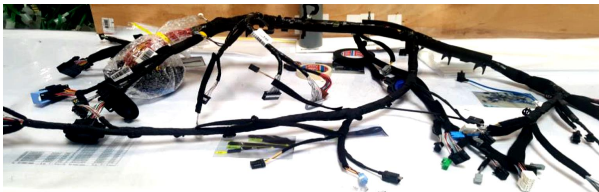
Figure 5 : Exemple d'un faisceau électrique
