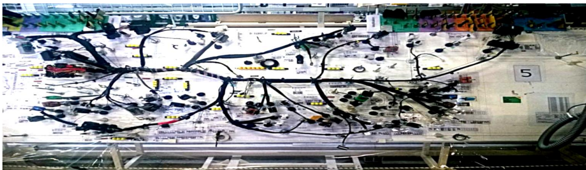
Figure 12 : JIG de la zone d'assemblage
