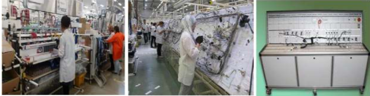
Figure 11: Les postes d'insertion, d'enrubannage et du test électrique successivement
