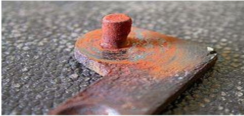
FIGURE 13: MECANISME D'USURE PAR CORROSION
