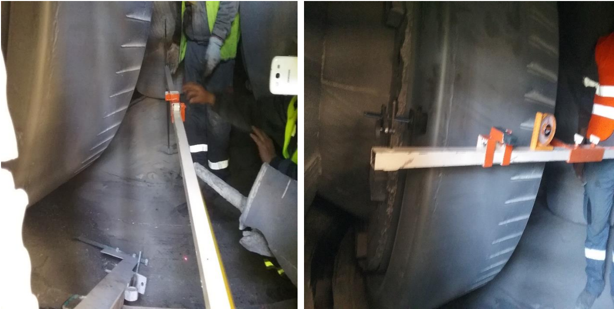
FIGURE 20:FIXATIONS REEL DU SYSTEME DE MESURE D'USURE
