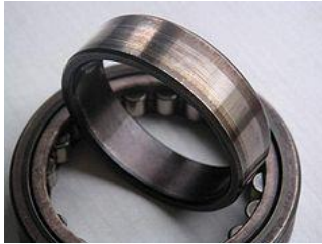
FIGURE 12: USURE DU ROULEMENT PAR ADHESION
