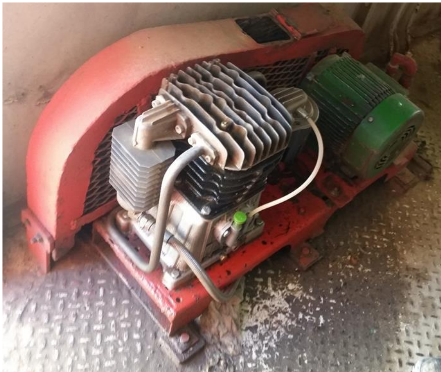
Figure 41 : L'installation pneumatique dans la machine Dragline 200B
