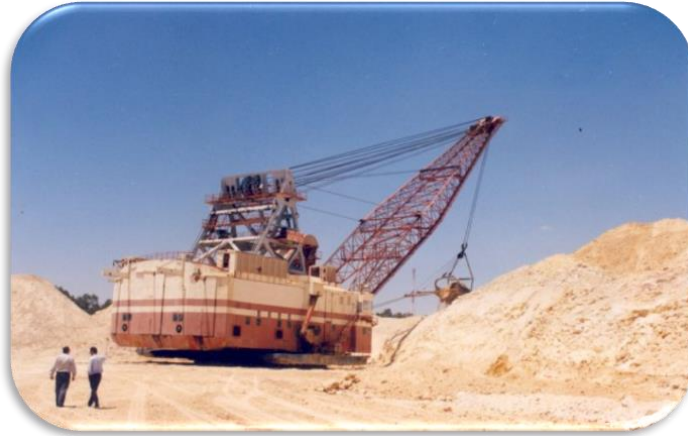
Figure 5 : Décapage par dragline 7900
