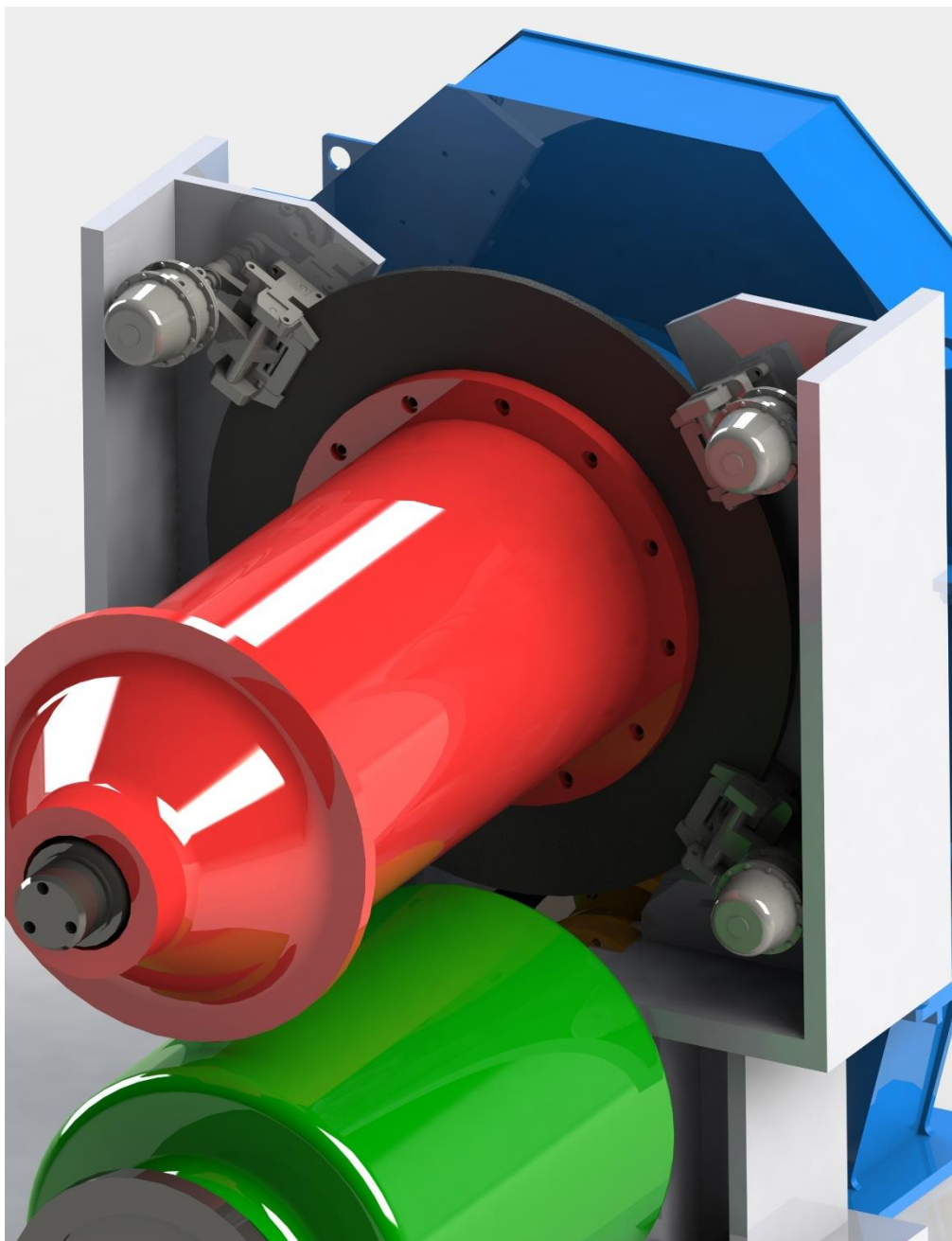
Figure 42 : Montage des freins sur le système de freinage
