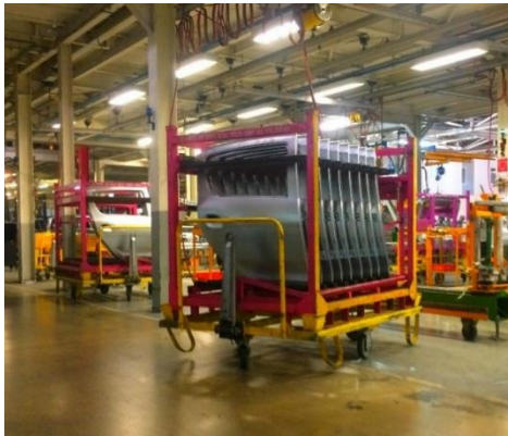
Figure 58 Positionnement non précis des chariots
