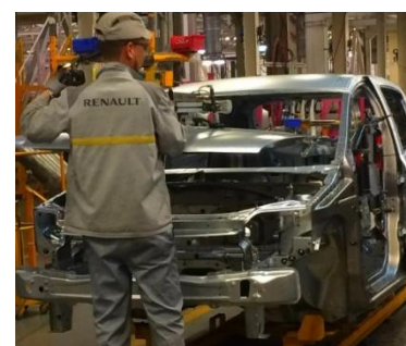
Figure 32 Montage du capot
