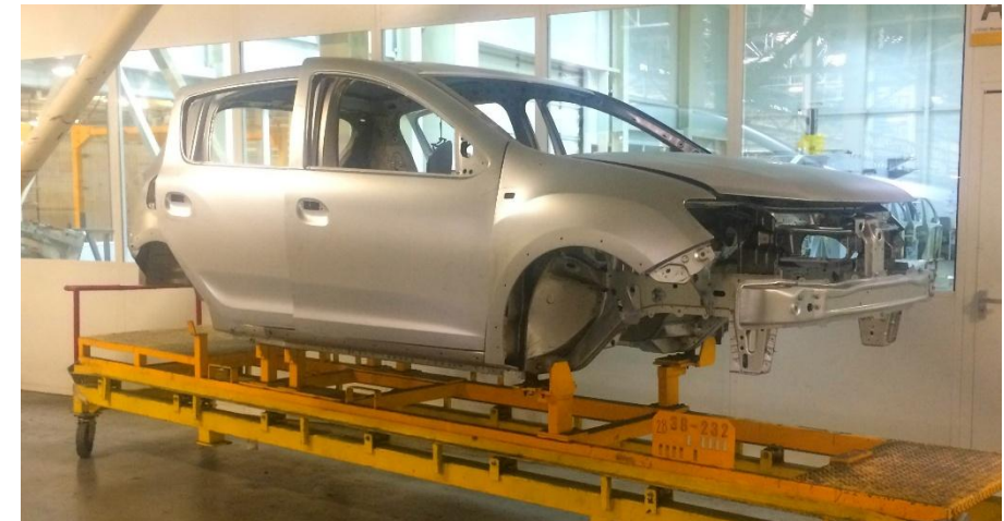
Figure 51 Etat finale de la caisse dans l'usine tôlerie
