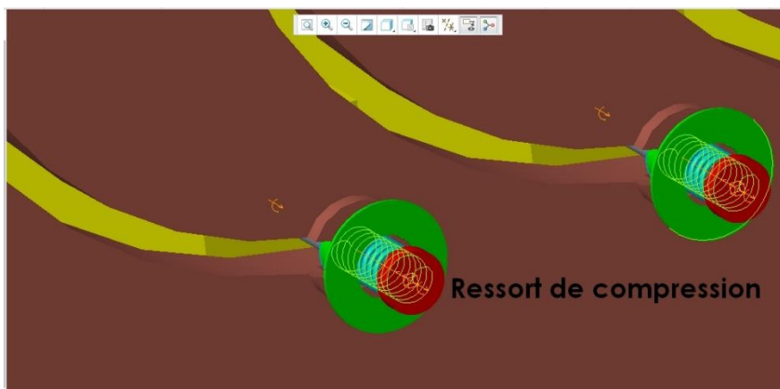
Figure 65 Ressort permettant le déverrouillage de la barre
