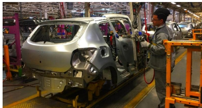
Figure 27 Montage de la porte arrière
