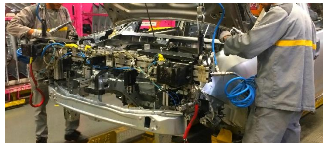
Figure 34 Vissage des ailes
