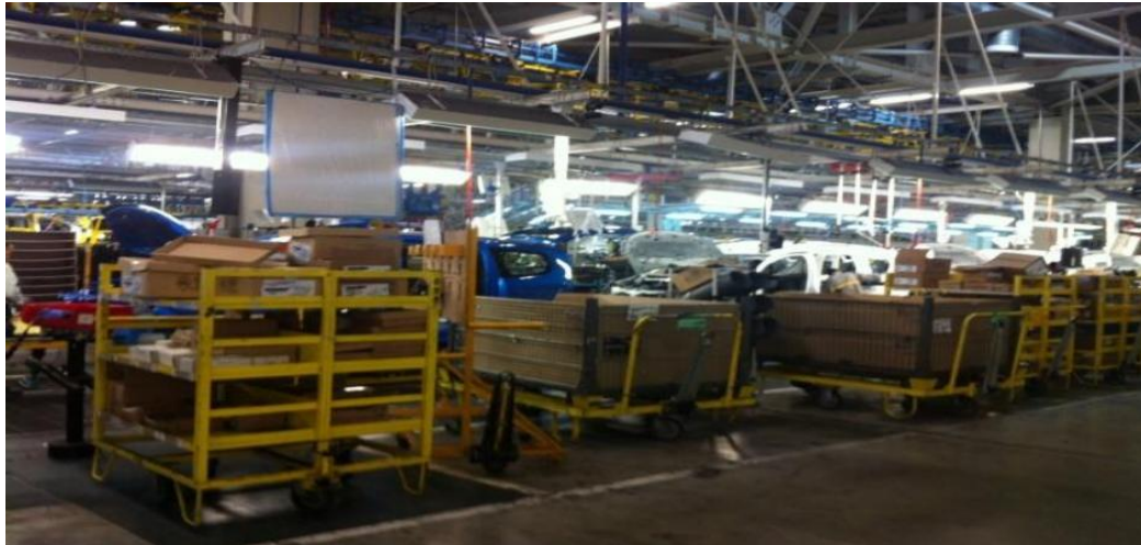
Figure 60 l'utilisation de la méthode Picking Kitting dans l'usine Montage
