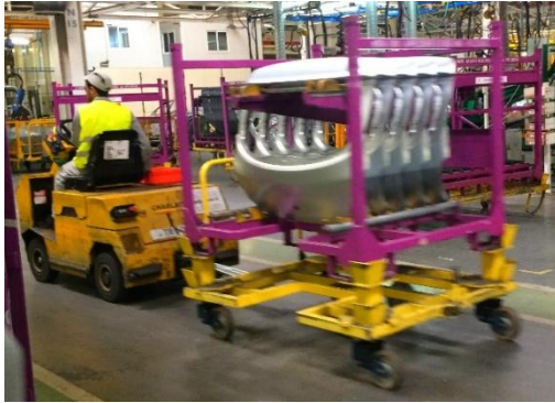
Figure 53 Transport des chariots de la zone de préparation vers la ligne de montage
