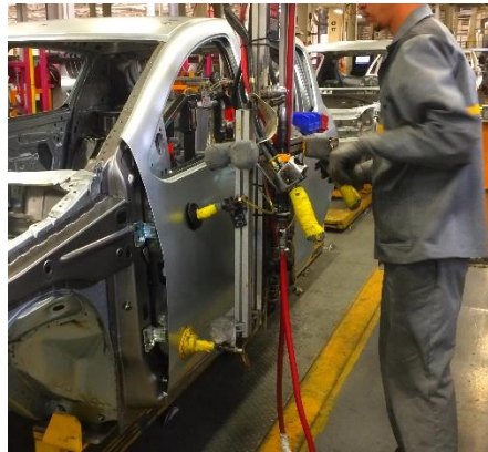
Figure 29 Montage de la porte avant
