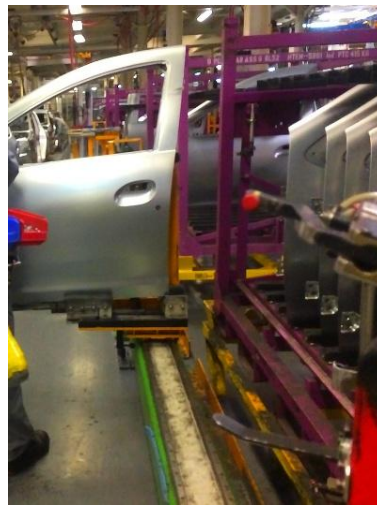
Figure 61 Support de déchargement des ouvrants
