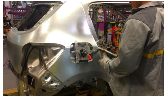
Figure 26 Vissages de l’acro-plaque
