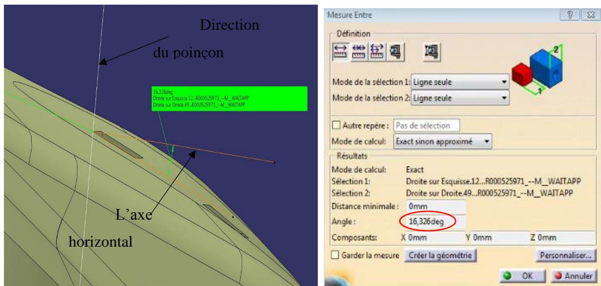
Figure 39 : l'angle d'inclinaison  $a$  du premier trou de passage
