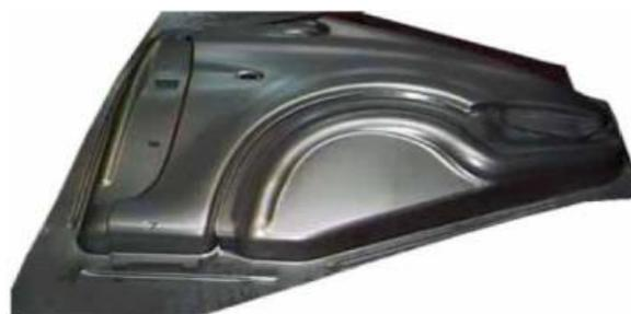
Figure 7 : emboutissage d'une aile avant
