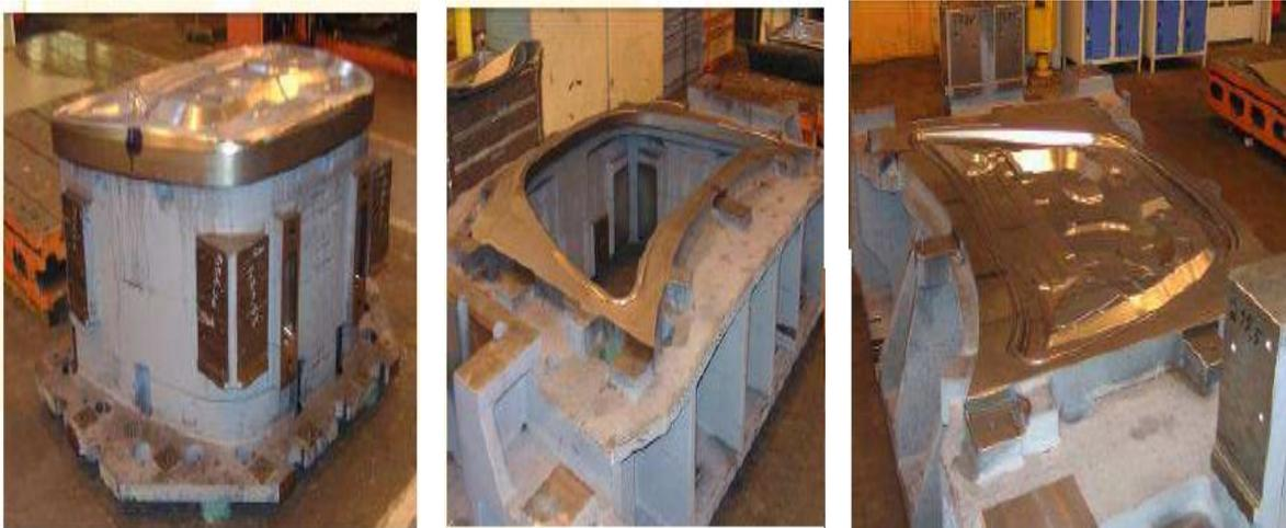
Figure 16 : l'outil d'emboutissage d'une doublure de capot
