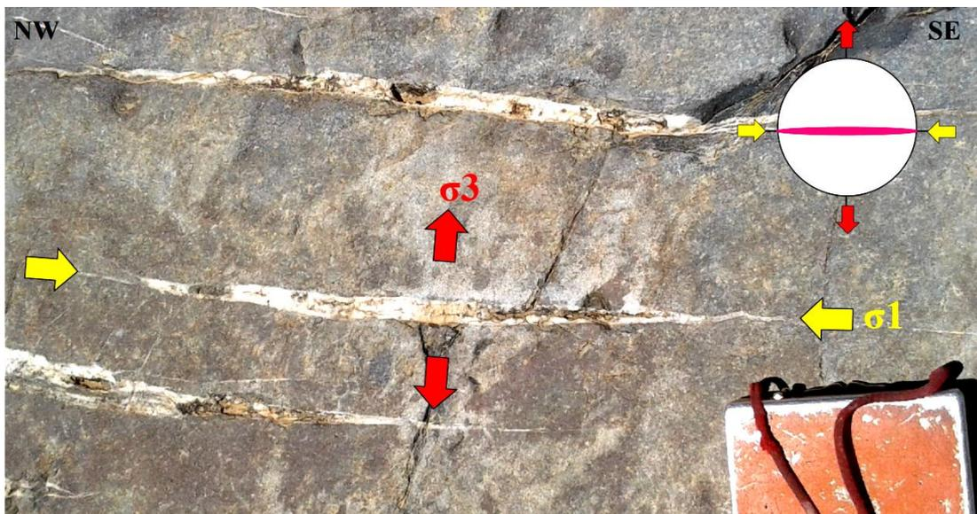
**Figure 41** : Fente de tension développée au sein des grès de PII
