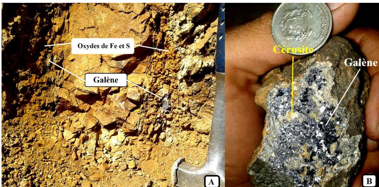
**Figure 66** : Structures à plomb : A) structure à galène massif et oxydes de fer et de soufre encaissés dans les pélites de PII. B) échantillon à galène et cérusite
