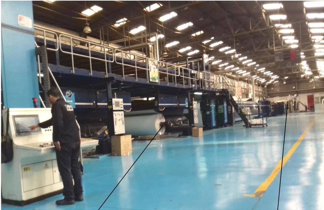
Figure 9: Onduleuse BHS - 2500mm
