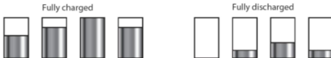
*Figure IV.6 : exemple de déséquilibre dans les deux phases (charge et décharge)*
