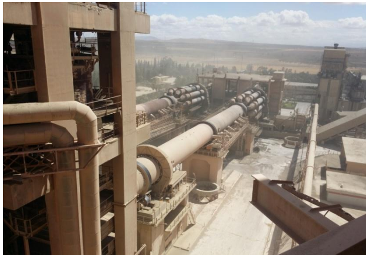
Figure 7 : Le four rotatif
