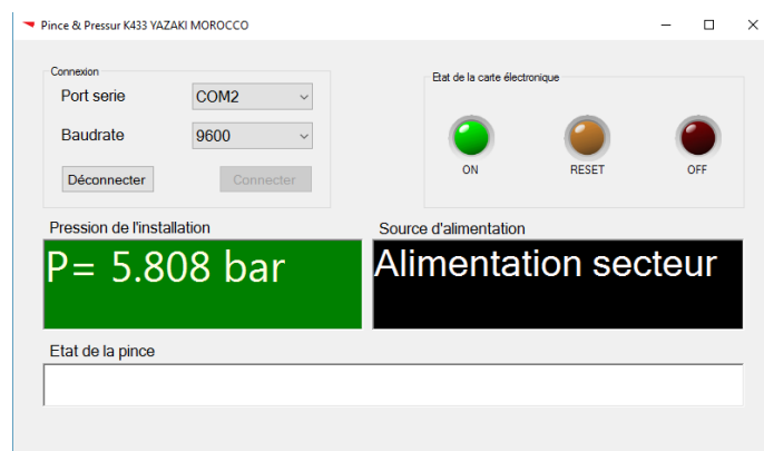
Figure 39 : L'interface graphique en fonctionnement normal
