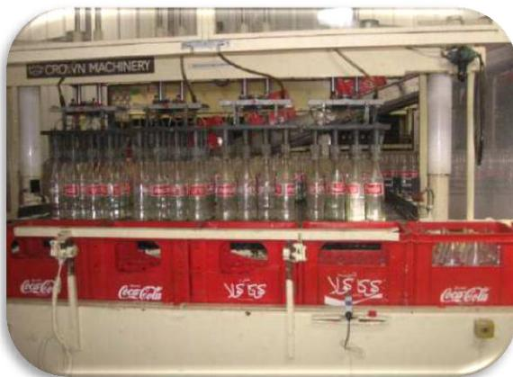
**Figure 10 :** Décaisseuse
