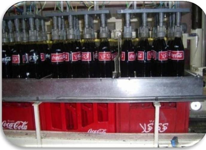
**Figure 19 :** Encaisseuse
