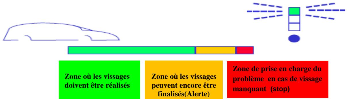
L'opérateur effectue le premier vissage. Si le coffret d'asservissement vissage envoie un compte rendu OK (le couple et l'angle de serrage sont bons), le compteur de vissage est incrémenté. Il effectue ainsi tous les serrages nécessaires jusqu'à ce que le compteur ait le nombre de vissage attendu.
