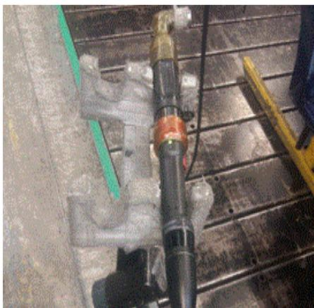
**Figure 12 : Visseuse électrique**
