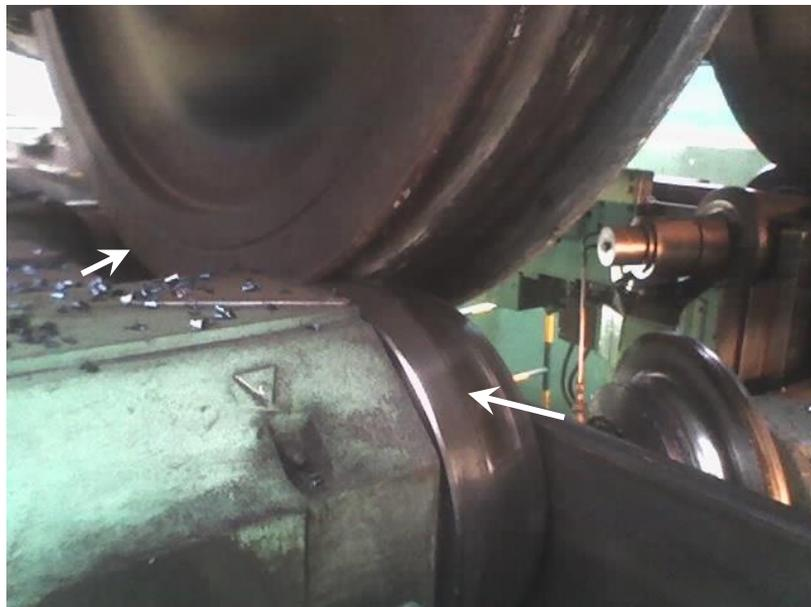
figure 13 : la roue et en contact avec les galets
