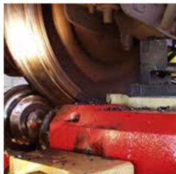
Une fois installé sur le tour en fosse, le train est déplacé grâce à un halage qui permet de le faire glisser jusqu'au positionnement souhaité.
