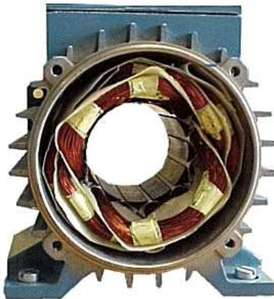
Figure 29:logement des bobines
