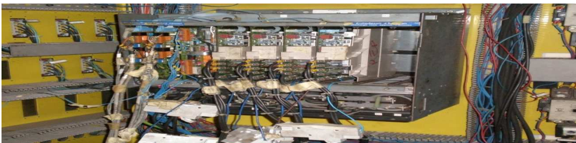
Figure 17 : Onduleur à modulation de largeur d'impulsion à transistors pour entraînements d'avance triphasée 6SC61-4A-Z
