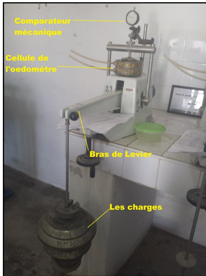
Figure II.11 : Appareillage de l'essai de compressibilité par palier à l'œdomètre.
