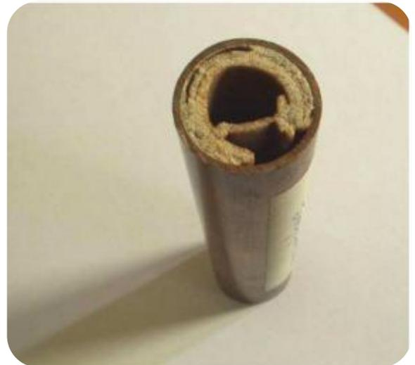
***Figure 8: Canalisation en cuivre avec dépôt de tartre***
