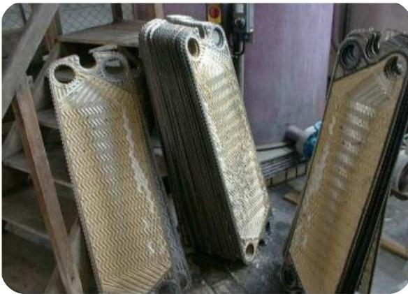
***Figure 7 : Echangeur thermique avec dépôt de tartre***
