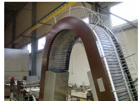
Figure 11: Tour de refroidissement
