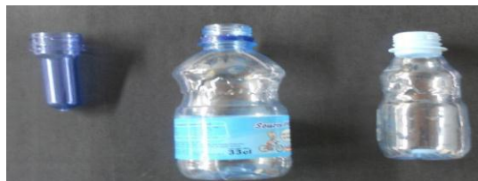
Figure6 : Evolution de la morphologie du PET Préforme amorphe, bouteille élaborée par soufflage/étirage La même bouteille après Un maintien à 110°C pendant 1 heure.
