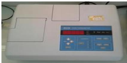
**Figure 9.** Turbidimètre
