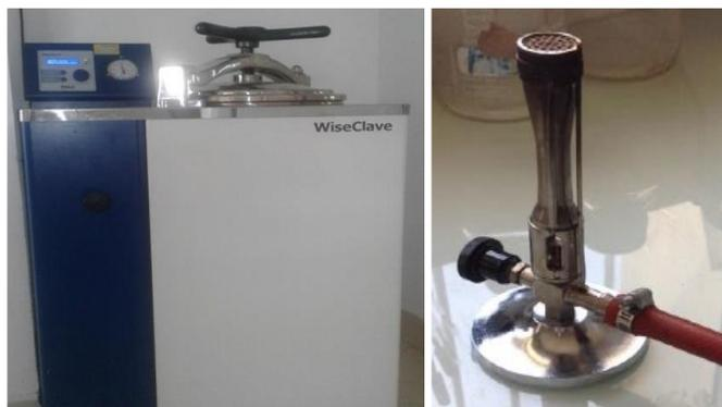
**Figure 6 .Bec bunsen-Autoclave**
