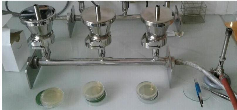
**Figure 7.** Appareil de Filtration sur membrane
