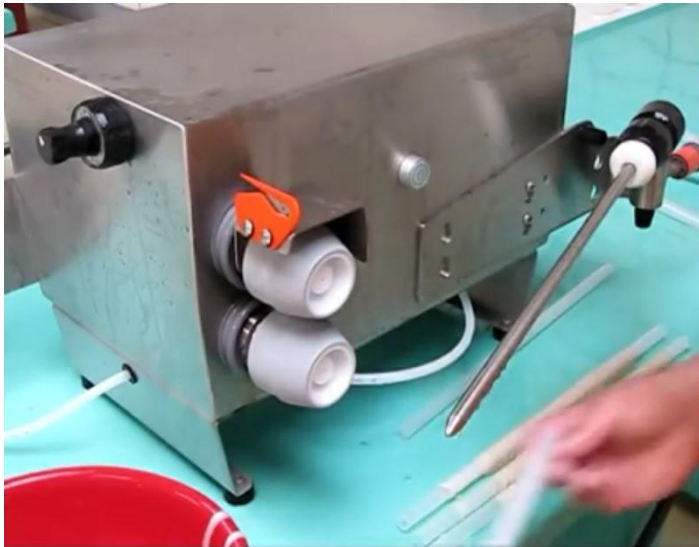
Figure N°7 : tubage de boyau
