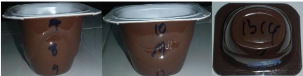
**Figure 9 : Mesure de l'épaisseur des pots vides**
