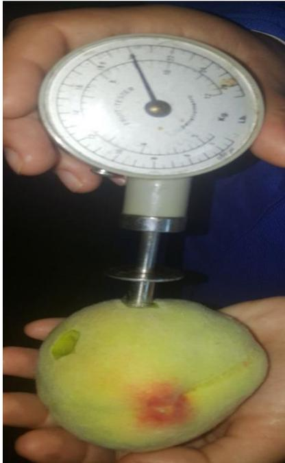
*Figure 17: Pénétrromètre.*
