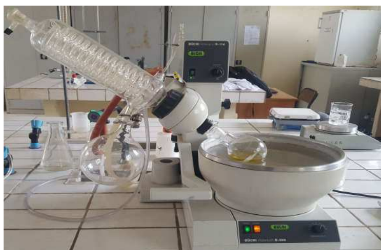
Figure 4 : Elimination du solvant par Rotavapeur
