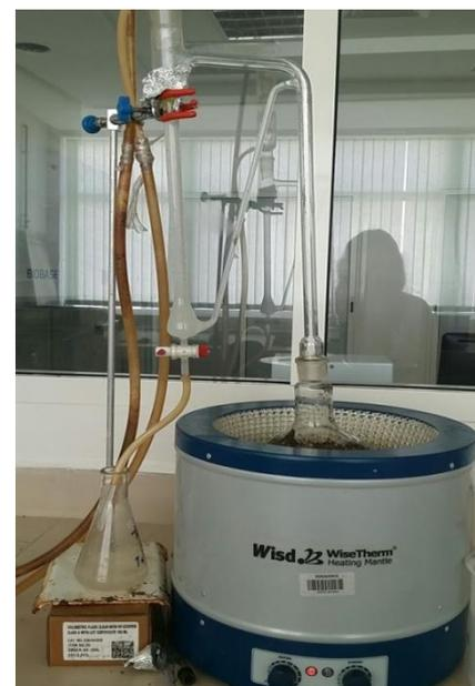
**Figure 15 :** Montage de l'hydrodistillation
