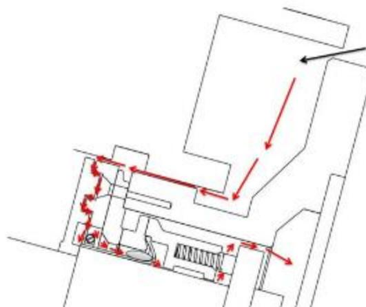
Figure 28: Circuit de pénétration de la matière
