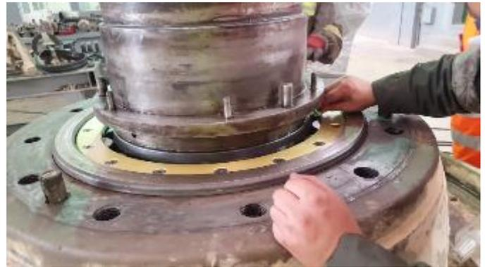
Figure 43 : Contrôle de roulement
