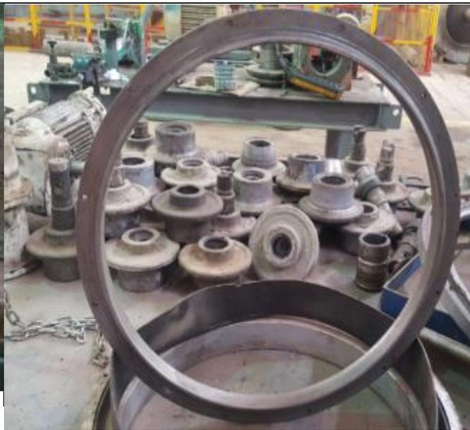
Figure 36: Bague d'usure
