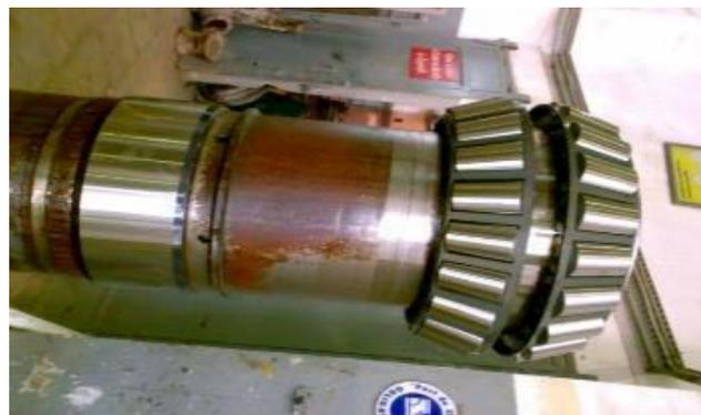
Figure 18 : Roulement NU et Conique
