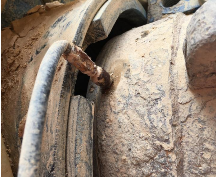
Position non correcte du graisseur automatique
