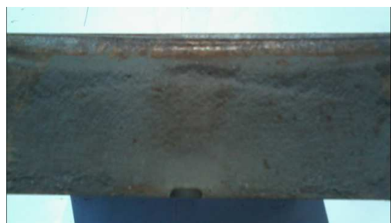
Figure 2.6: vue des deux surfaces de la rupture du poinçon du moule CN30
