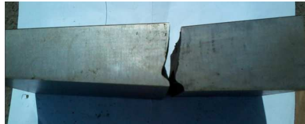
Figure 2.5 : vue de dessus du poinçon cassé du moule CN30
