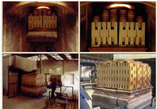
Figure 1.5: l'étape de cuisson des briques
