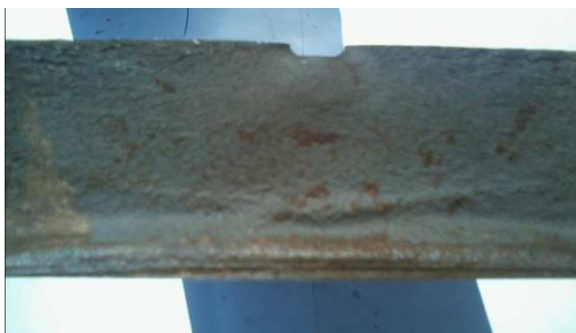
Figure 2.6: vue des deux surfaces de la rupture du poinçon du moule CN30
