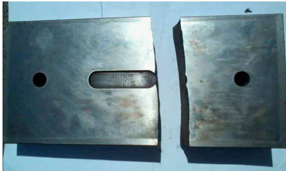
Figure 2.4 : vue de faces du poinçon cassé du moule CN30
