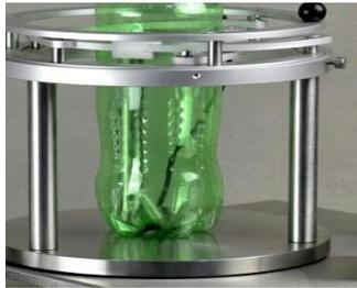
Exemple 1 : qui se rassemble d'une cage permet de fixer la bouteille de sa surface supérieure d'une manière circulaire, lié par des tiges réalisent la fixation de la partie précédent par la base qui porte l'outil.
