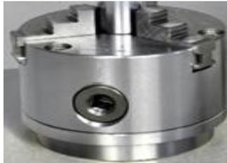
Exemple 2 : un système s'intéresse a utiliser le mandrin a 3 mors utilisé a l'opération du tournage, en utilisant un clé pour son ouverture et sa fermeture
