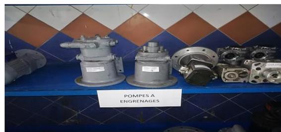
Figure 41 : les pompes à engrenages après l'aménagement
