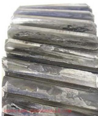
Figure 33: Usure d'un engrenage
