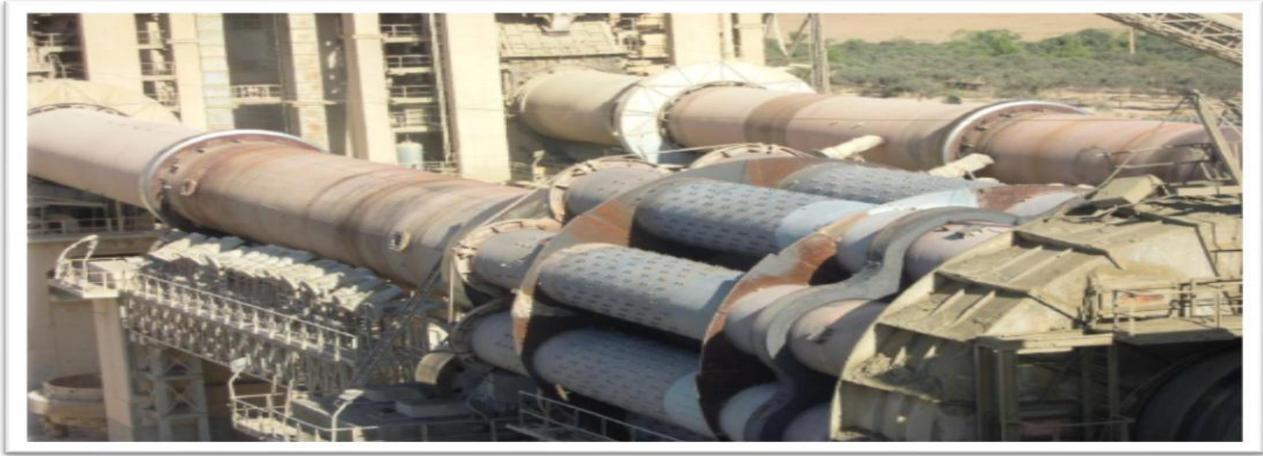
Figure 14: Four rotatif à ballonnets (1).
