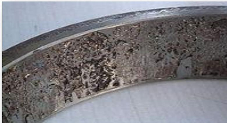
Figure 32:Grippage d'une bague.
