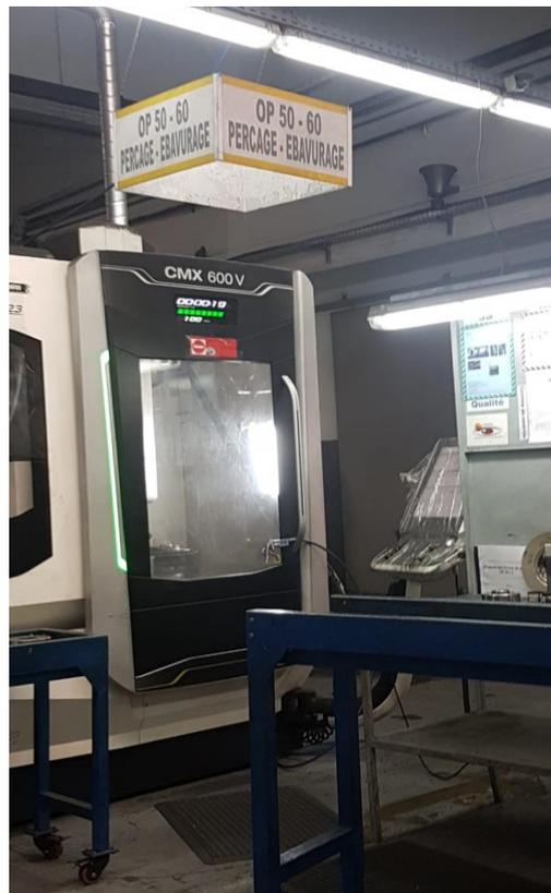
Figure 5 : Machine de Perçage- ébavurage
