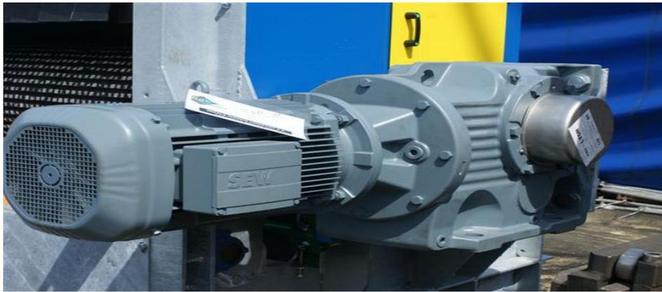
Figure 32 : Moteur réducteur convoyeur
