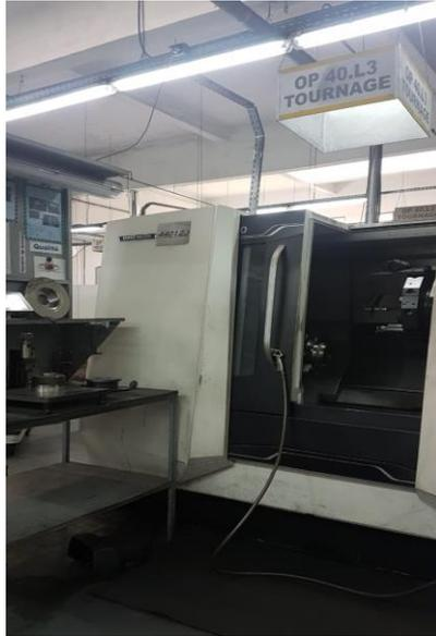
Figure 4 : Machine de chanfreinage
