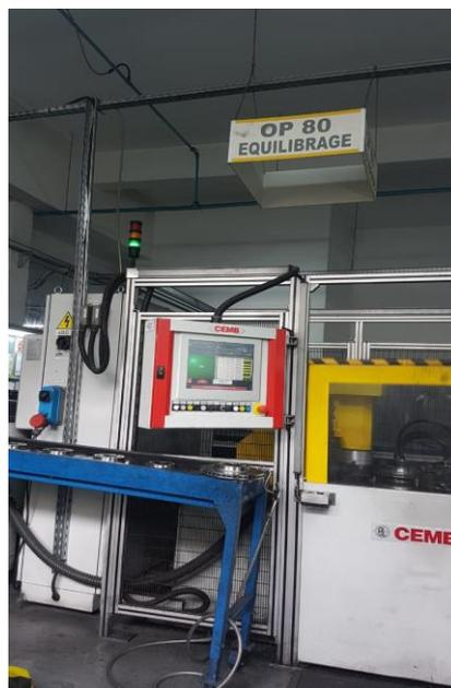
**Figure 7 : Machine d'équilibrage**
