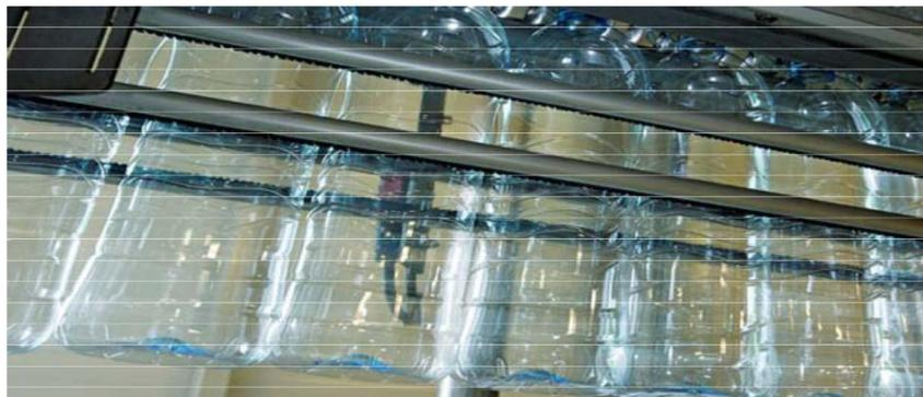
Figure 24 : Convoyeur à air
