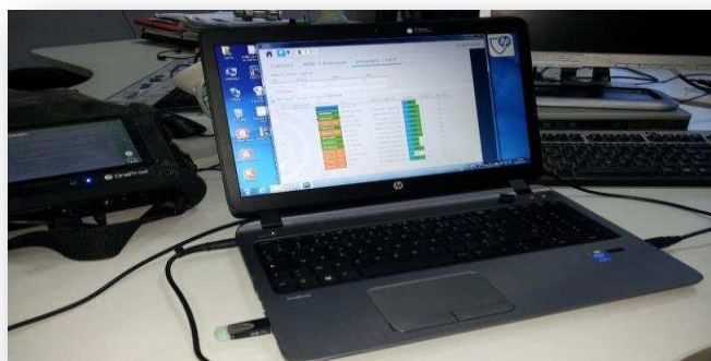
Figure 23: Déchargement des machines à surveiller dans le collecteur FALCON
