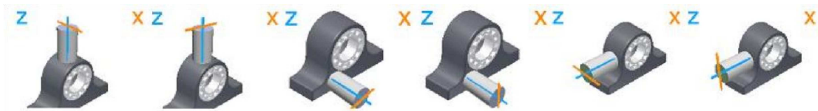
Figure 24: les Pictogrammes à sélectionner selon la position du capteur sur le palier pour un arbre horizontal
