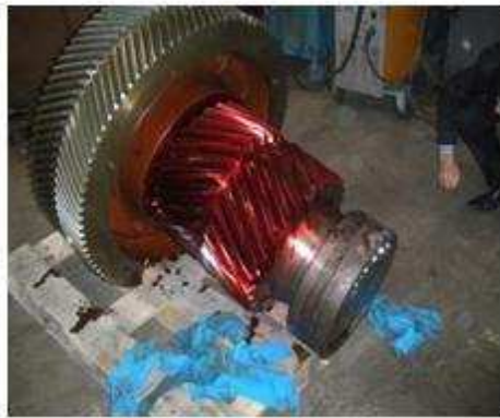
Figure 10: Opération de ressuage effectué sur les roues du réducteur BK4
