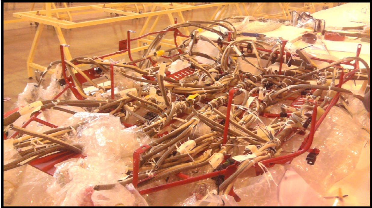
Figure 12 Rampe avec harnais intégré
