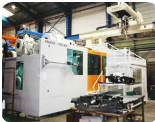
Fig.1.10 : Exemple d'une machine d'injection
