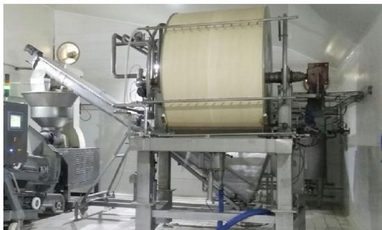
**Figure 6 : Filtre rotatif de la levure**
