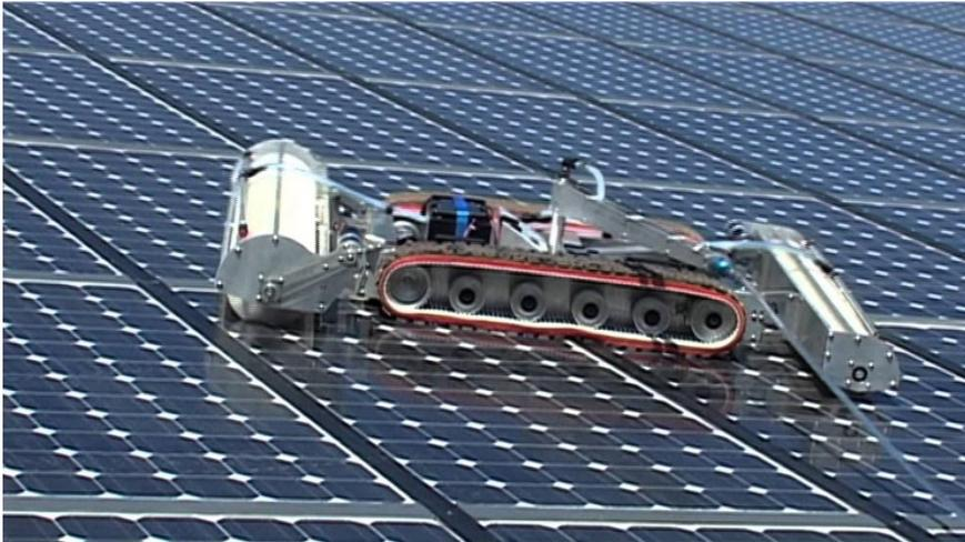
**Figure 9** : Robot nettoyeur des panneaux photovoltaïques.
