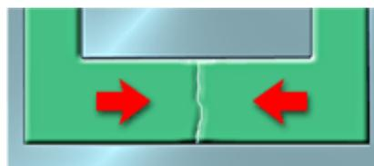
**Figure 22 : ligne de soudure**
