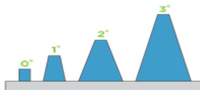
**Figure 21 : Divers angles de dépouille**
